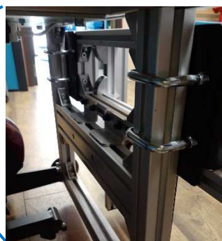
角Uボルトにての手摺に締結する ※締結トルク:5.2N・m
